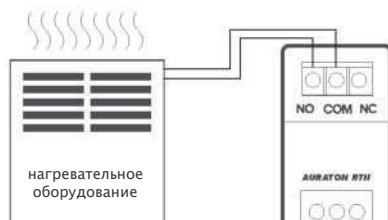
Упрощенная схема соединения AURATON RTH с отопительным оборудованием
