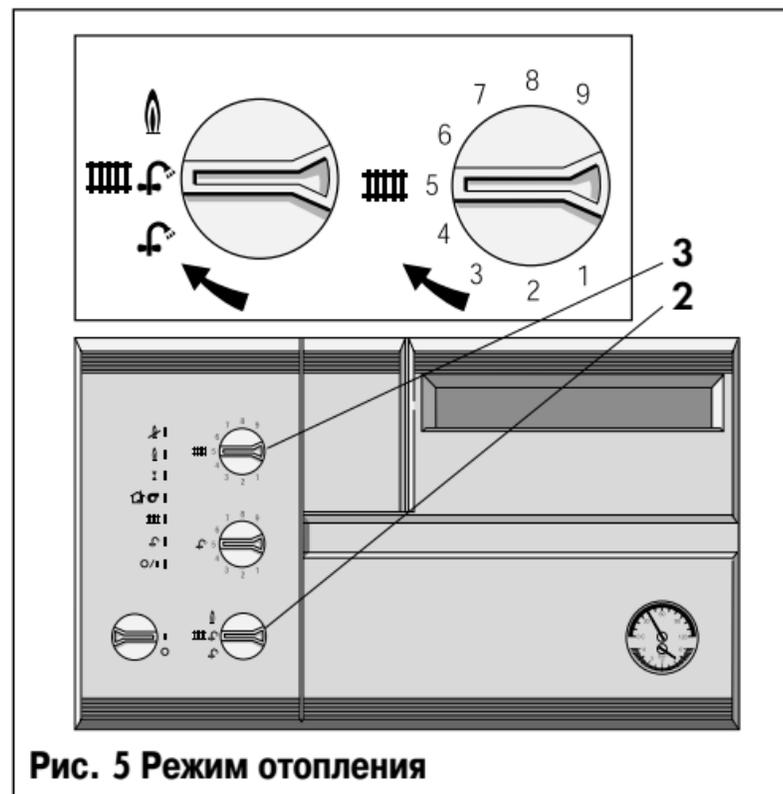
Рис. 5 Режим отопления
