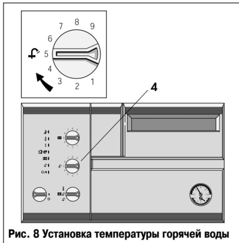
**Рис. 8 Установка температуры горячей воды**
