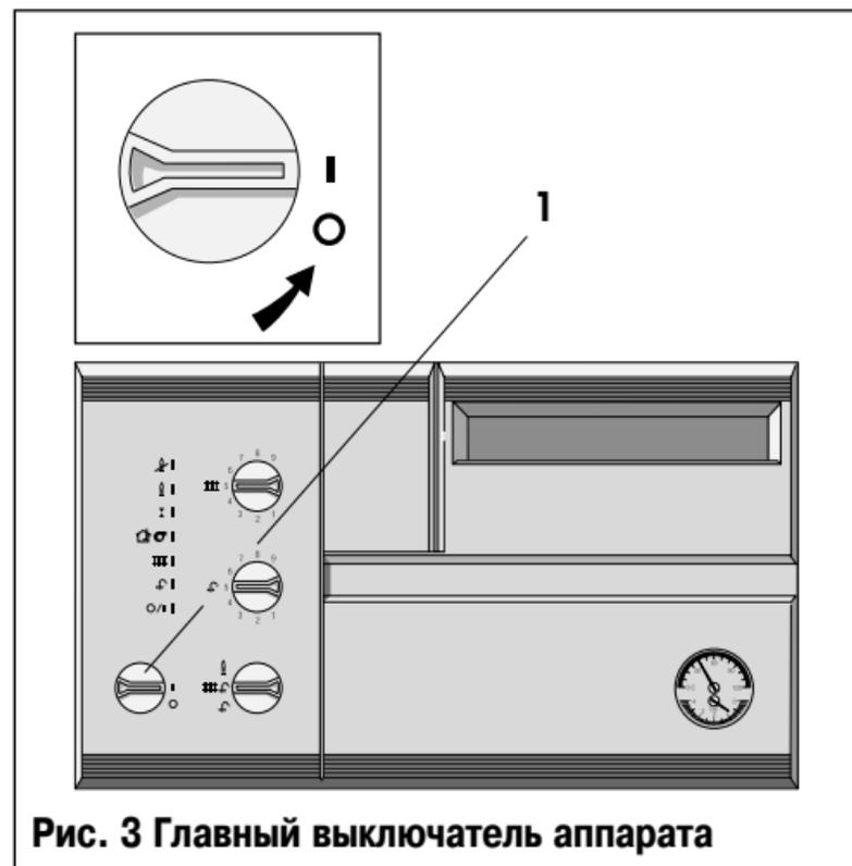
**Рис. 3 Главный выключатель аппарата**
