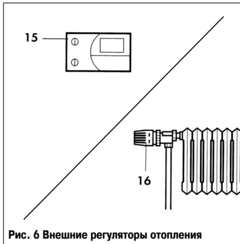
Рис. 6 Внешние регуляторы отопления
