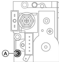
Отпустить, не вывинчивания, резьбовую пробку в измерительном патрубке **(A)** комбинированного газового регулятора и подсоединить манометр.
