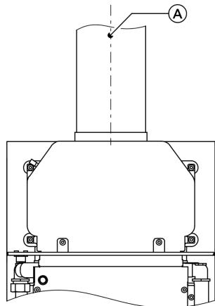
1. Подключить газоанализатор к измерительному отверстию (A).
