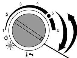
Повернуть ручку регулятора "I" вправо до упора (оставить на короткое время в этом положении) и затем обратно. Светодиодные индикаторы "I" и "III" одновременно мигают.
