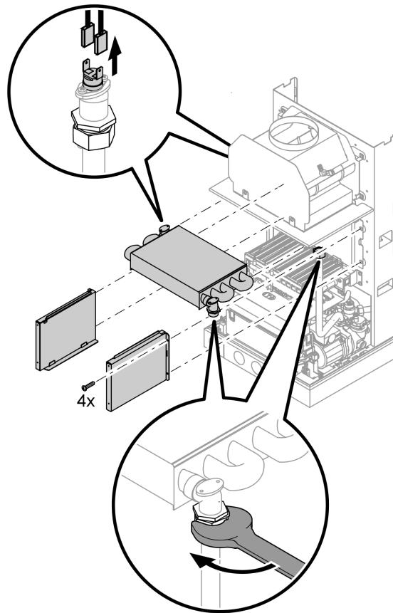
Отпуская резьбовые соединения со стороны греющего контура, придержать вторым гаечным ключом.
