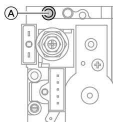
Отпустить, не вывинчивая, винт в измерительном патрубке А и подсоединить манометр.
