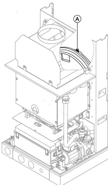
Проверить давление на входе мембранныго расширительного бака **(A)** на измерительном ниппеле, при необходимости добавить содержимое.
