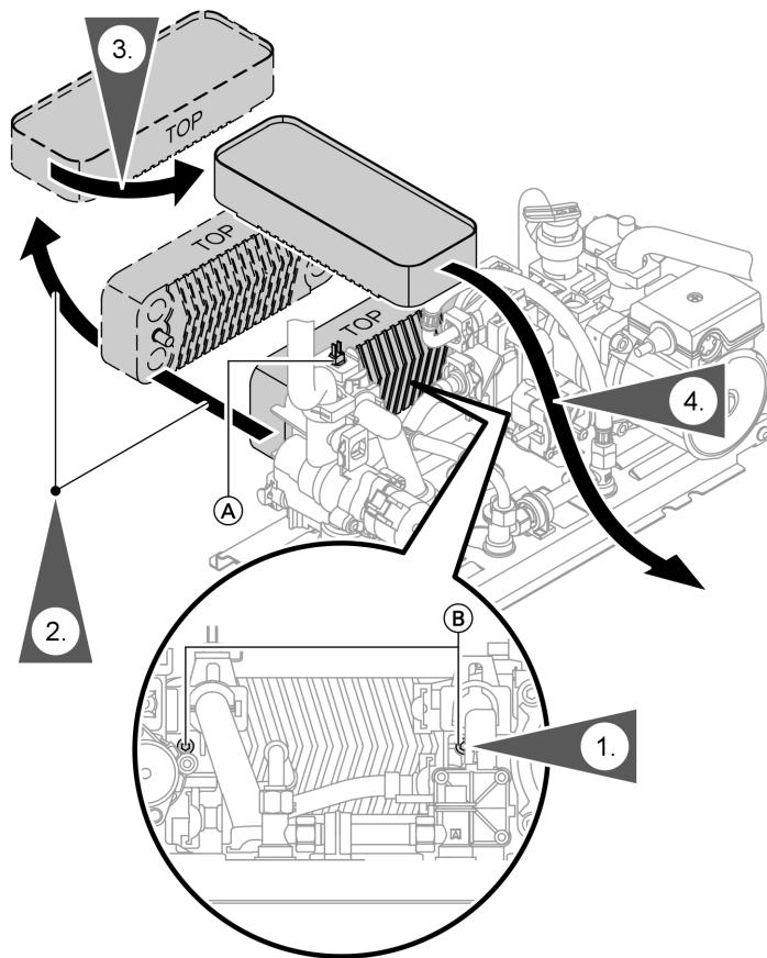
Ⓐ Датчик температуры на выходе
