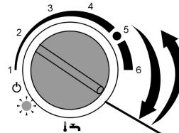
Повернуть ручку регулятора "I II" вправо до упора (оставить на короткое время в этом положении) и затем обратно. Светодиодные индикаторы "I II" и "I III" одновременно мигают.
