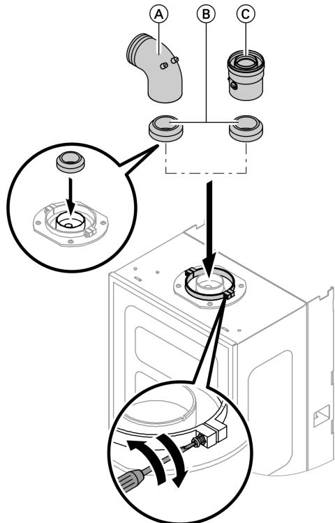
Ⓐ Присоединительный отвод котла для горизонтального монтажа системы удаления продуктов сгорания 60/100
