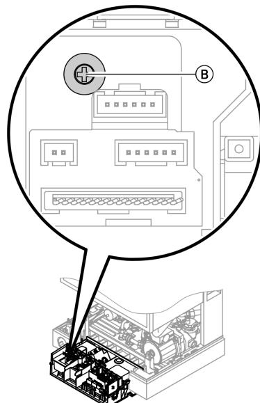
7. Повернуть потенциометр (B) отверткой влево настолько, чтобы давление газа на жиклере по манометру соответствовало требуемой тепловой мощности согласно таблице на стр. 26.
