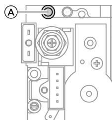
Отпустить, не вывинчивая, винт в измерительном патрубке А и подсоединить манометр.
