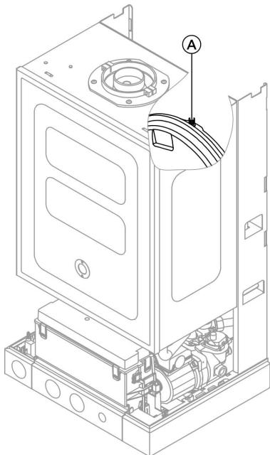
Проверить давление на входе мембранного расширительного бака **A** на измерительном ниппеле, при необходимости добавить содержимое.
