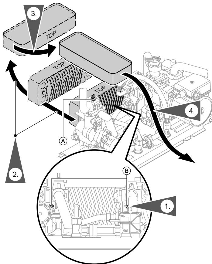
Ⓐ Датчик температуры на выходе
