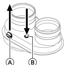
1. Подключить аналитический прибор к измерительному отверстию (A).
