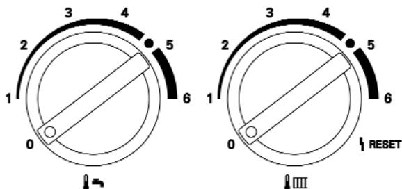
Повернути обидві ручки регулятора на «0». Для водогрійного котла активна функція контролю захисту від замерзання.
