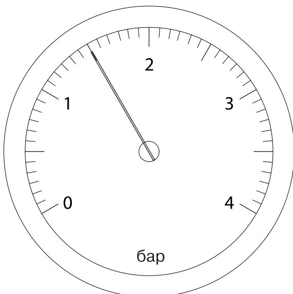
1. Перевірити тиск теплоносія опалювальної установки за манометром.
